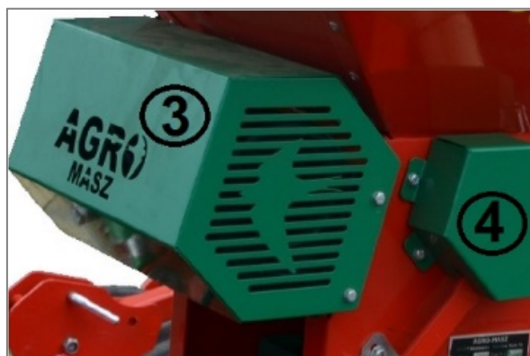
Pokrov ventilatorja (3) in pogonskega pasu mešalca (4).
