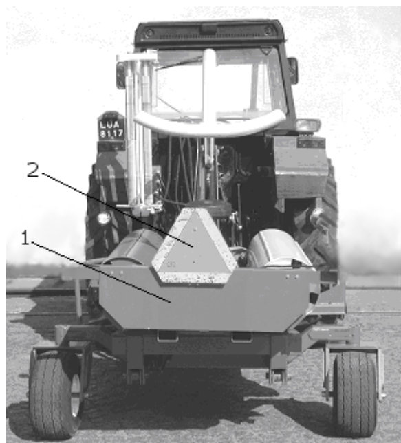
Sl. 15 Ovijalka bal Z-557 v transportnem položaju - izgled od zadaj:
