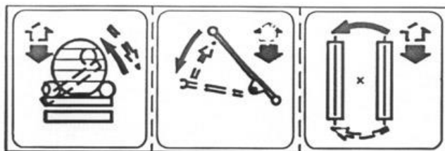
Sl. 6 Označitev funkcije vzvoda hidravličnega razdelilnika.
