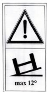
Sl. 5 Pozor: Maksimalni nagib terena, pri katerem je še dovoljeno delati s strojem.
