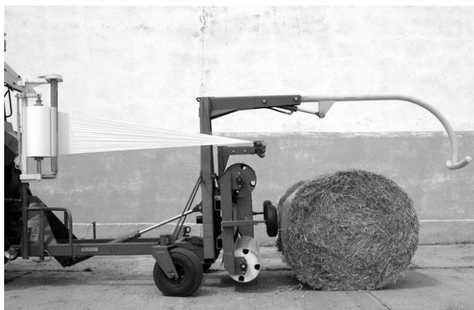
Sl. 22 Način pristopa z ovijalko k bali
