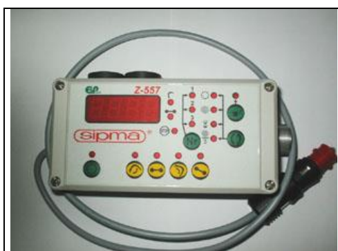
Sl. 27 Krmilna naprava ovijalke
