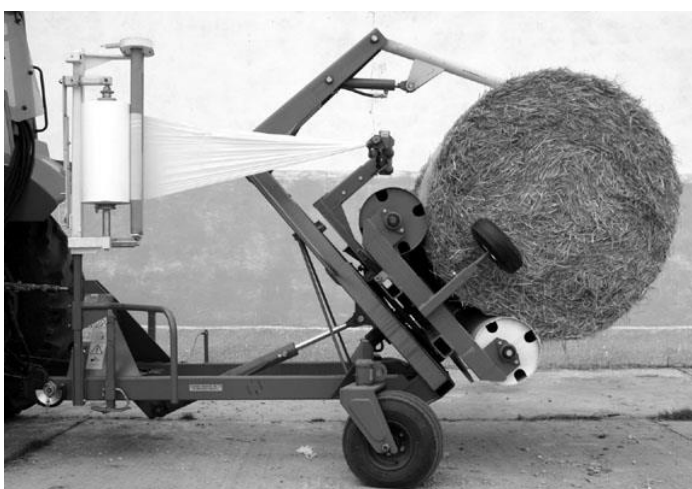
Sl. 22 Način pristopa z ovijalko k bali
