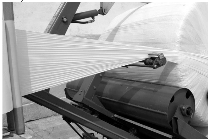
Sl. 25 Položaj folije v grabilno-rezilnem elementu pri nagibu okvirja
