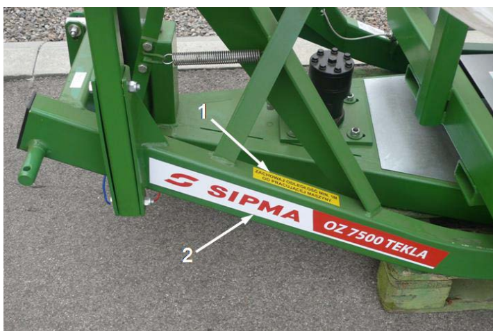
Sl. 15. Razporeditev nalepk – pogled z leve strani ovijalnega stroja: 1 – informativni piktogram; 2 – OZ 7500 P nalepka.
