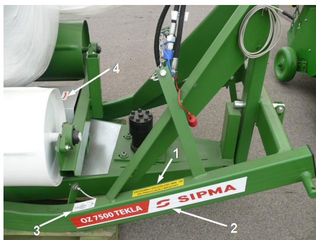
Sl. 16. Razporeditev nalepk – pogled z desne strani ovijalnega stroja: 1 – informativni piktogram; 2 – OZ 7500 L nalepka; 3 – sestav senzorja števca ovijalnega stroja; 4 – smer rotacije.
