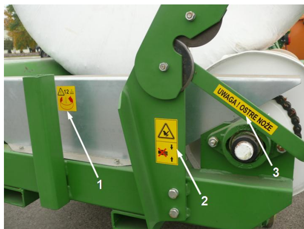
Sl. 18. Razporeditev nalepk – pogled na zadnjo stran ovijalnega stroja:
